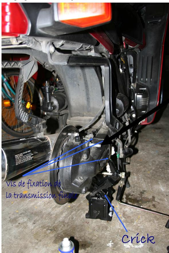
et jouer sur la hauteur du bras oscillant via le crick pour aligner les fixations du cadre et de l'amortisseur (partie haute).
