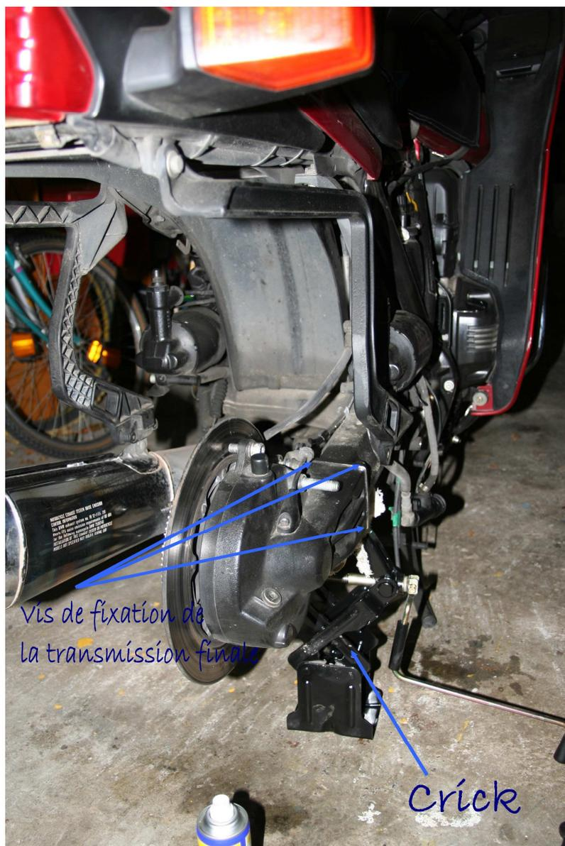
IL n'y a pas de risque de faire tomber par terre la transmission finale dans la mesure où il y a deux ergots rentrant dans le bras oscillant et retenant la transmission finale.
