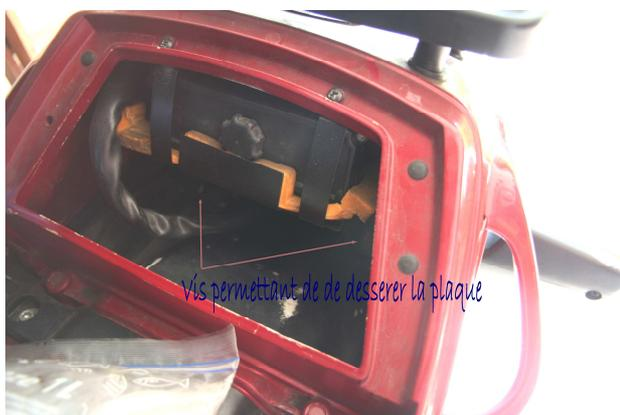
Il n'est pas nécessaire d'enlever le calculateur ABS pour dévisser ces vis
