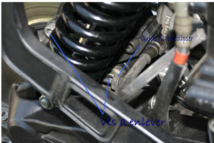
Une fois ces fixations enlevées, l'étrier s'enlève facilement. Il suffit de tirer dessous en faisant des petits mouvements de droite à gauche et d'avant en arrière pour extraire l'étrier.
