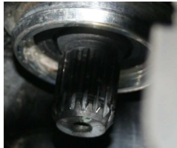
**Tous les éléments ont été nettoyés au white spirit puis enduit de graisse Belray : cannelures, pivots droit et gauche, intérieur du soufflet du bras oscillant ainsi que les roulements situés de part et d'autre du bras oscillant.**
