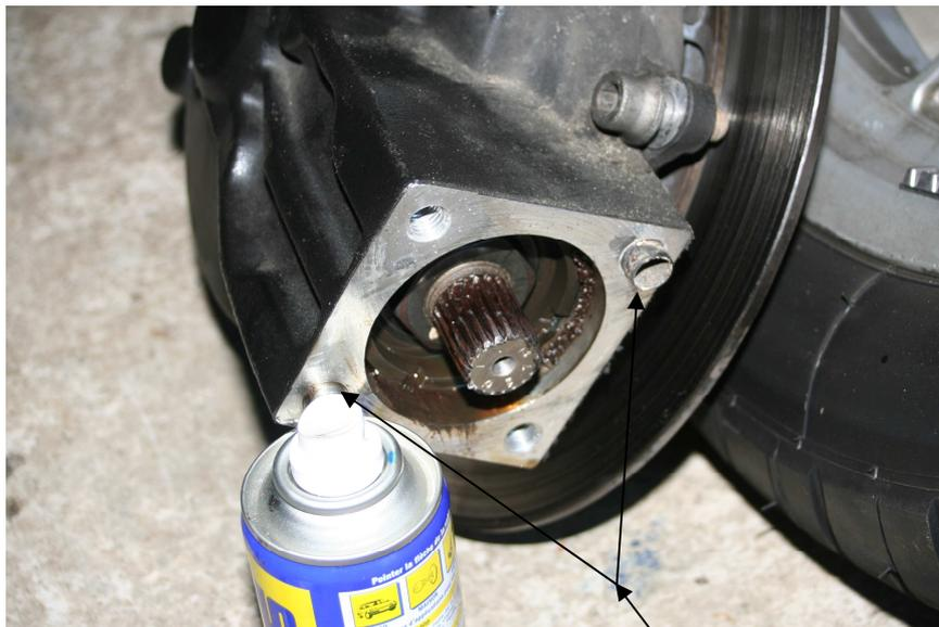
On distingue sur cette photo les 2 ergots permettant le centrage de la transmission au remontage. Par ailleurs, cela permet à la transmission finale de tenir en place même les quatre vis enlevées.
